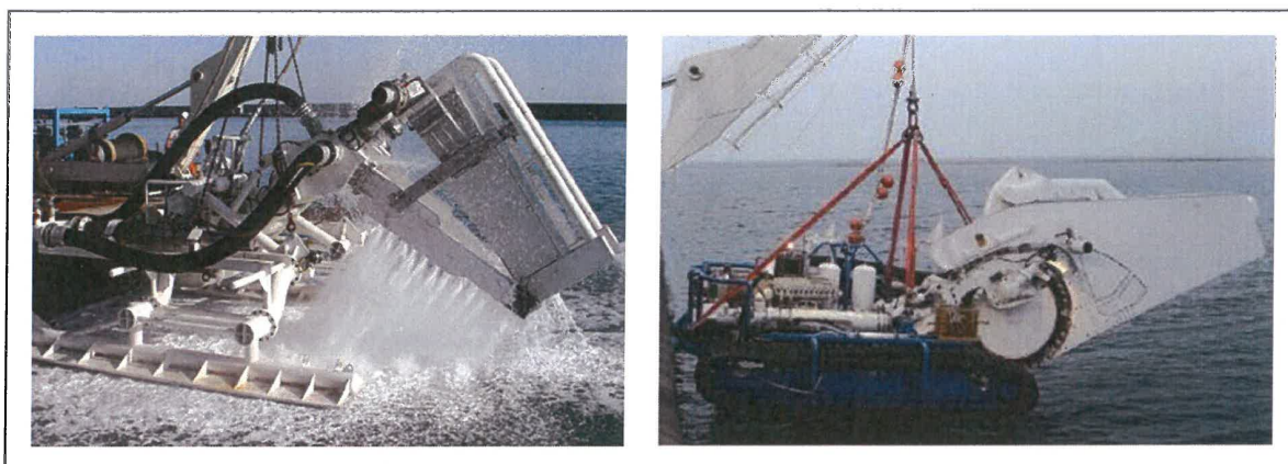
Figure 12 : A gauche : exemple d'outil d'ensouillage par jetting ; à droite : exemple de trancheuse
