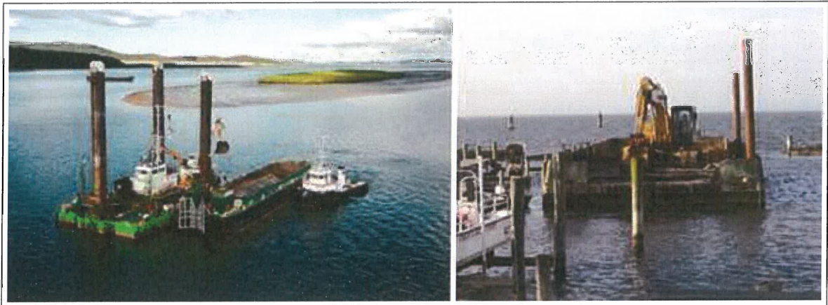
Figure 14: A gauche : pelle rétro-caveuse, ici avec navire sablier et remorqueur ; à droite : pelle mécanique sur barge
